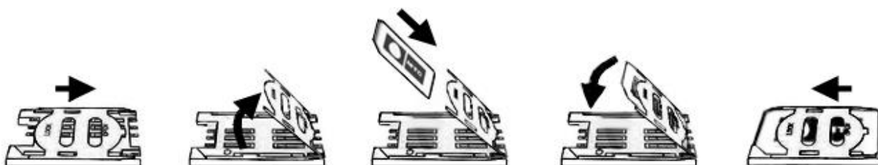
Рисунок 2. Порядок установки SIM-карт в слот
