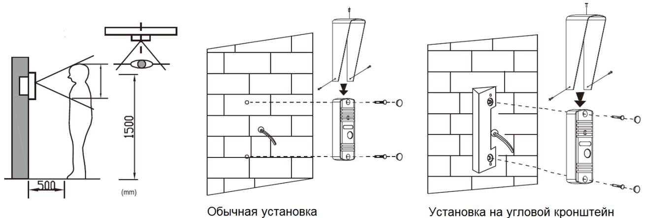
1. Выберите подходящее место установки вызывной панели. При выборе места установки избегайте возможности попадания прямого солнечного света или встречного освещения на видеокамеру.
