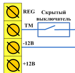
Рис. 8.2. Схема подключения скрытого выключателя
