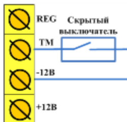
Рисунок 6.4 — Схема подключения скрытого выключателя
