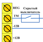
Рис. 7.16. Схема подключения скрытого выключателя
