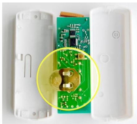
Рис. 7.5. Установка резервного элемента питания в радиоизвещатель Ладога-МК-РК
