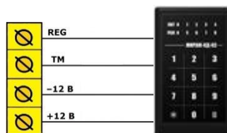
Рис. 7.15. Схема подключения кодовой панели Мираж-КД
