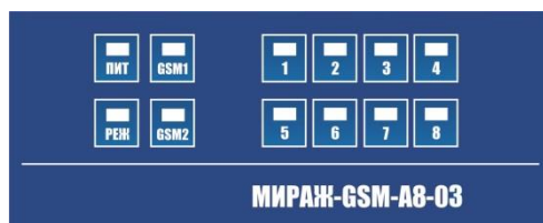
Рис. 3.2. Лицевая панель контроллера
